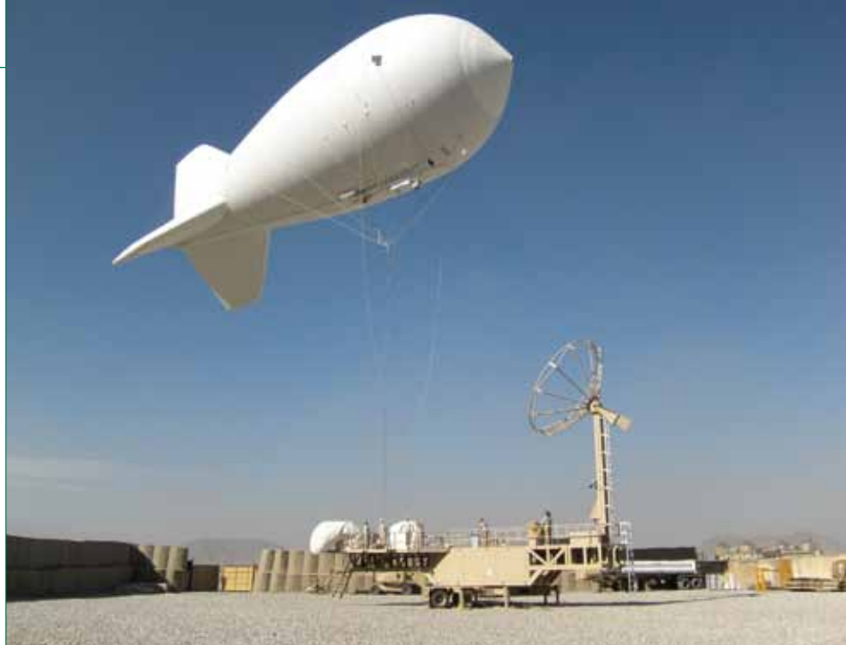
Das Persistent Thread Detection System (PTDS) wird von der US-Armee in Afghanistan zur Raumüberwachung eingesetzt.
